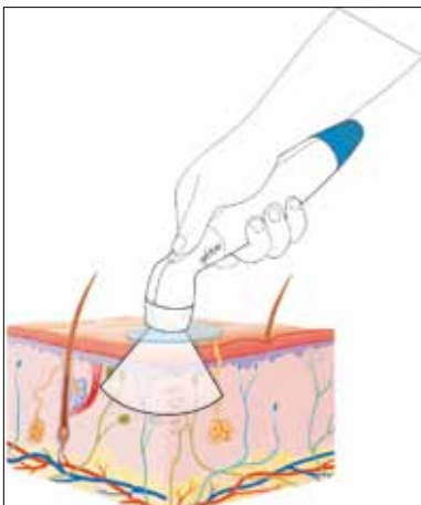
Emisión Continua Frecuencia 3 MHz Profundidad de penetración 2,5 cm aprox.
